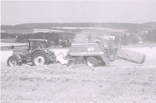
Abb. 2. Vorbauhäcksler an Grossballenpressen zerkleinern das Stroh bereits auf dem Feld. Die Staubbelastung und die Brandgefahr des Strohmahlens entfallen. Der Zerkleinerungsgrad hängt von der Einstellung und der Fahrgeschwindigkeit ab.
