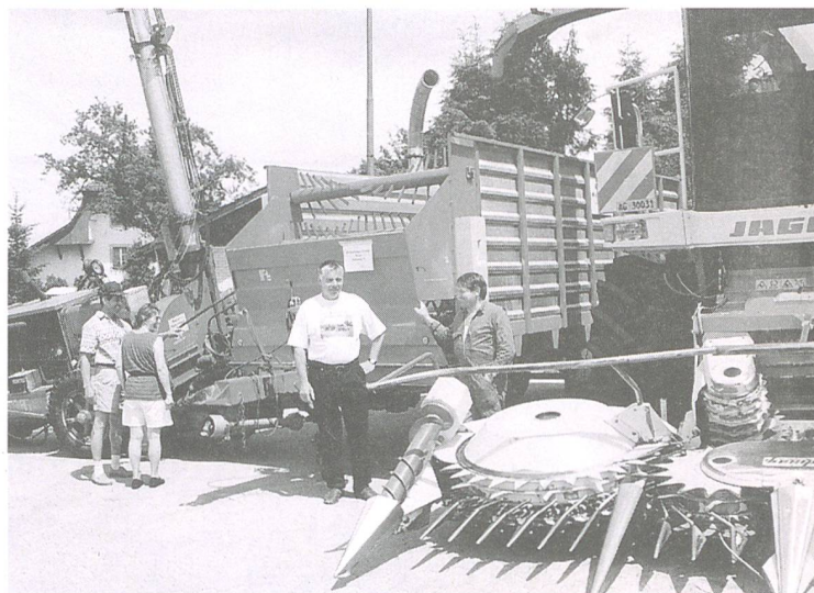
Neueste Technologie im Lohnunternehmen von Fritz Maurer (rechts) und Werner Wullschleger: Im Hintergrund die selbst konstruierte, hydraulisch gesteuerte Gebläseleitung.
