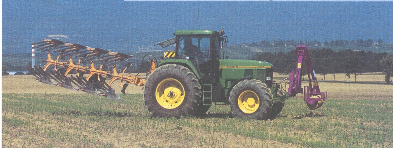
Abb. 4. Front und Heck: Die wichtigsten Anbauräume am Traktor.
