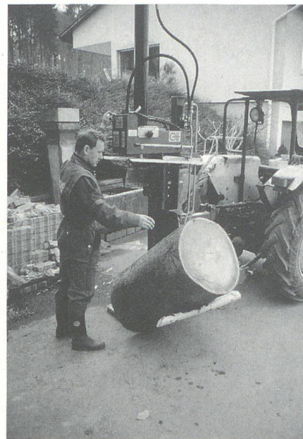
Hydraulische Hubvorrichtung, um schwere Brocken mübeloser aufzurichten und in die Spaltposition zu bringen.
