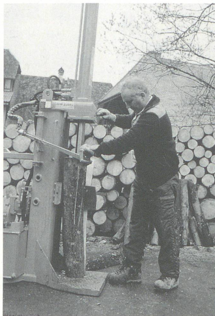
An die Zweihandschaltung muss man sich gewöhnen. Wichtig ist ein beweglicher Arm, mit dem das Holzstück oben festgehalten und geführt wird.
