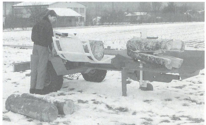
Ammeter: Pezzolato: Typ SMBL 33 Spalkkraft 33 Tonnen, zweistufiger Spaltvorgang, hydraulisch verstellbare Höhe des Spaltkeils, Holzlänge 1300 mm, Spaltbüh 1200 mm, Stamm- heber-Hubkraft 480 kg, Gewicht 990 kg, aufgebauter Honda Benzin-Motor. Preis: Fr. 18 500.-.
