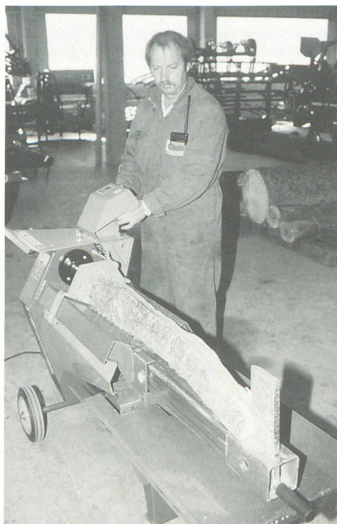
Horizontalspalter mit beweglicher Stossplatte links und einziehbarem Keil rechts zur Herstellung von kurzem oder langem Stückholz. (Bilder: Ueli Zweifel)
