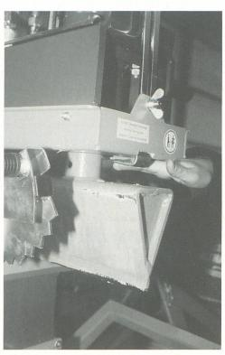
Flexibler Auslöse- und Festhaltegriff links. Ein Endanschlag bei total eingezogenem bzw. ausgestossenem Spaltkeil verbindert Klemmverletzungen.
