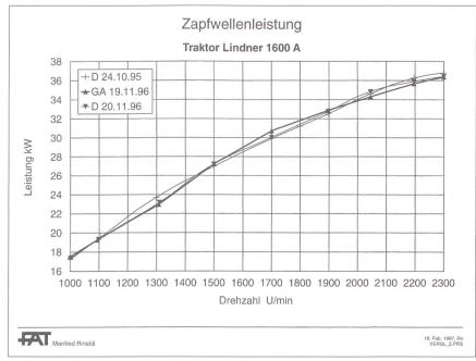
Abb. 5. Zapfwellenleistung in Abhängigkeit der Motordrehzahl. D bedeutet Diesel, und GA steht für das mit einem kommerziellen Additiv im Verhältnis 1:1000 ergänzte Gemisch.
