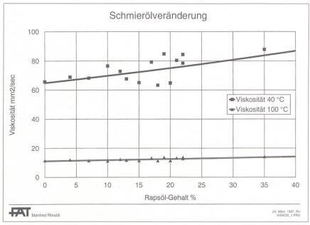
Abb. 19. Viskositätsveränderung bei 40 °C und 100 °C (entspricht Betriebstemperatur).
