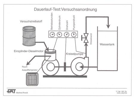
Abb. 15. Versuchsanordnung für 1000-Stunden-Dauerlauftests.
