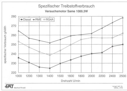
Abb. 11. Spezifischer Treibstoffverbrauch bei der Messung nach Abbildung 10.
