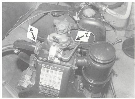
Abb. 17. Anordnung der Messstellen für Abgastemperatur A und Zylinderdruck Z.
