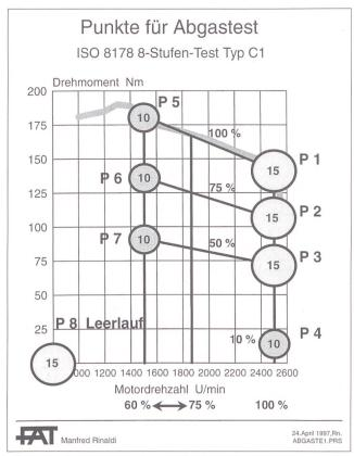
Abb. 13. Lastpunkte des 8-Stufen-Abgastest nach ISO 8178, Typ C1. Dargestellt sind die einzelnen Messpunkte mit ihrer jeweiligen Gewichtung.
