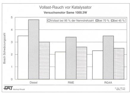
Abb. 12. Die Rauchwerte von additiviertem Gemisch (RG4A) entsprechen denen von Rapsmethylester (RME). Dieselöl hat in allen Lastpunkten höhere Rauchwerte.
