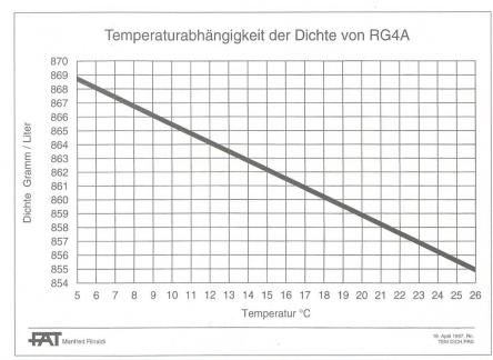
Abb. 4. Verlauf der Dichte von RG4A in Abhängigkeit von der Temperatur.
