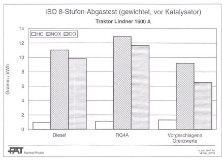
Abb. 8. Verglichen mit den von der Europäischen Union (EU) vorgeschlagenen Grenzwerten haben sowohl Dieselöl als auch RG4A bei Stickoxiden ( $NO_x$ ) und Kohlenmonoxid (CO) zu hohe Werte. Die unverbrannten Kohlenwasserstoffe (HC) sind beide Male niedriger.
