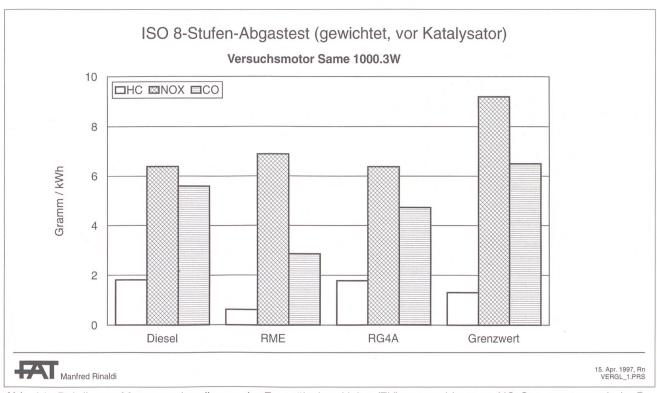
Abb. 14. Bei diesem Motor werden die von der Europäischen Union (EU) vorgeschlagenen HC-Grenzwerte nur beim Betrieb mit Rapsmethylester (RME) eingehalten. Die  $NO_{X^-}$  und CO-Grenzwerte werden bei allen Treibstoffen eingehalten.
