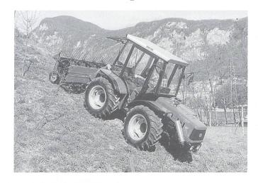
Der neue BCS-Wendetraktor Vanguard MT800 des italienischen Herstellers ist bestückt mit einem VM-4-Zylinder-70-PS-Motor mit Direkteinspritzung. Das bringt eine Brennstoffeinsparung bis zu 30%, mehr Durchzugskraft bei niedriger Drehzahl und ein höheres Drehmoment.
