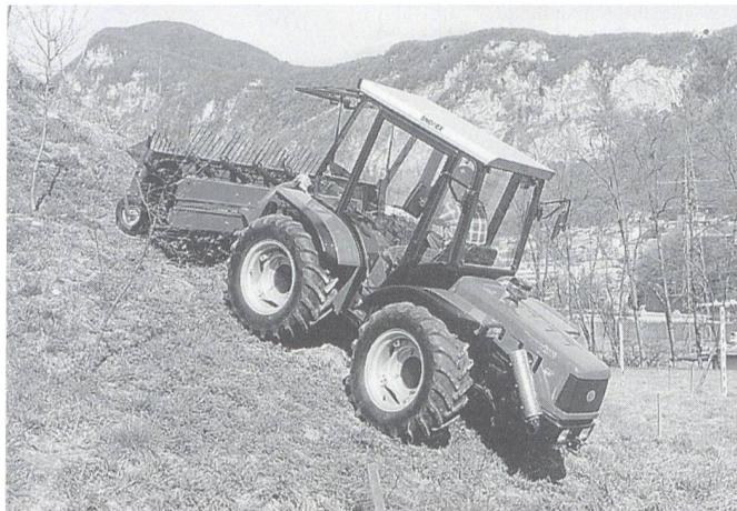
Der neue BCS-Wendetaktor Vanguard MT800 des italienischen Herstellers ist bestückt mit einem VM-4-Zylinder-70-PS-Motor mit Direkteinspritzung. Das bringt eine Brennstoffeinsparung bis zu 30%, mehr Durchzugskraft bei niedriger Drehzahl und ein höheres Drehmoment.
