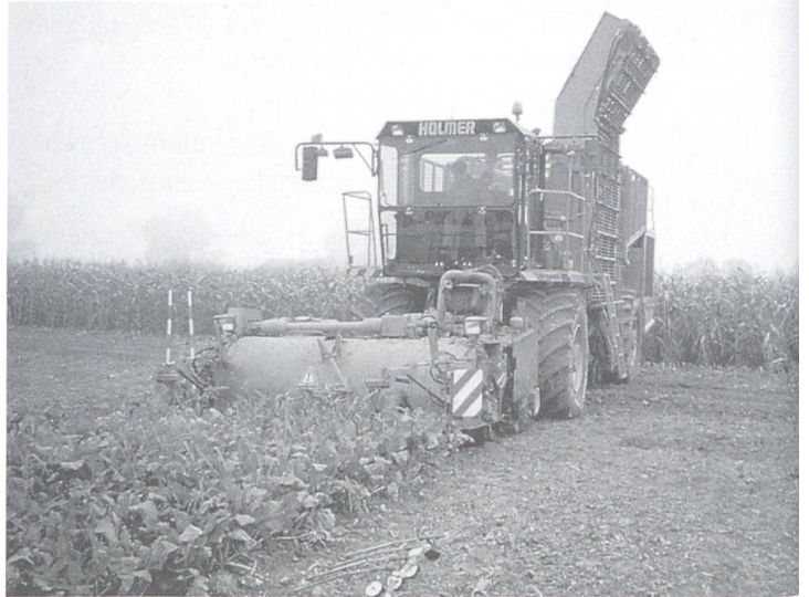
Abb. 5: In der Versuchsreihe eingesetzte Maschinentypen L1/96 (gezogener zweireihiger Vollernter, links) und S1/95 (selbstfahrender sechsreihiger Vollernter, rechts). Bilder: FAT.
