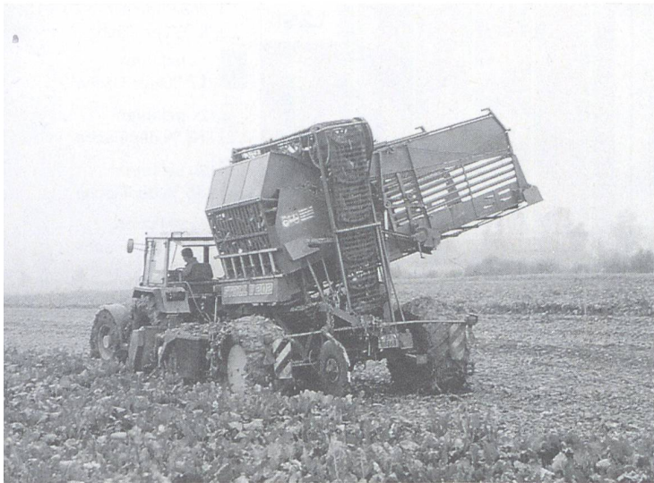
Abb. 5: In der Versuchsreihe eingesetzte Maschinentypen L1/96 (gezogener zweireihiger Vollernter, links) und S1/95 (selbstfahrender sechsreihiger Vollernter, rechts). Bilder: FAT.
