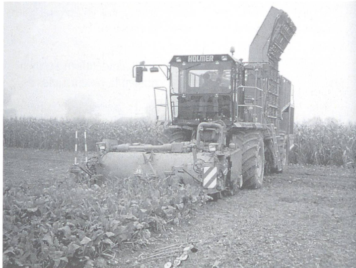
Abb. 5: In der Versuchsreihe eingesetzte Maschinentypen L1/96 (gezogener zweireihiger Vollernter, links) und S1/95 (selbstfahrender sechstreihiger Vollernter, rechts). Bilder: FAT.
