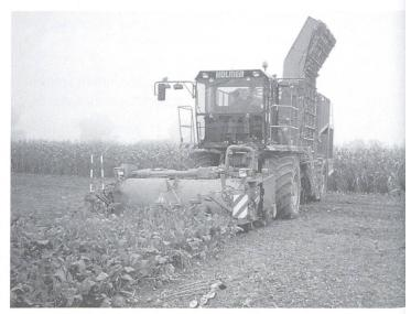
Abb. 5: In der Versuchsreibe eingesetzte Maschinentypen L1/96 (gezogener zweireibiger Vollernter, links) und S1/95 (selbstfahrender sechsreibiger Vollernter, rechts). Bilder: FAT.
