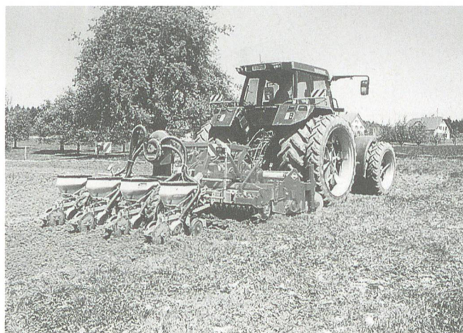
Maxxum 5140 mit der Saatkombination EL 121/Planter II im Feldeinsatz. Die Planter II ist vom Traktor aus hydraulisch angetrieben.
