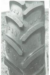
Neue Stollengeometrie für gute Bodenhaftung und hervorragende Selbstreinigung.
