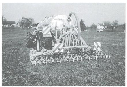
Abb. 13. Schlitzdrillmaschine (gezogene Ausführung): nur noch wenig Ammoniakverluste, doch was sagen unsere Böden zum Gesamtgewicht von über 14 t (ohne Traktor)?
