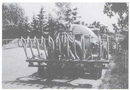
Abb. 9. Schleppschuhverteiler gelten im Ausland für die Verwendung im Futterbau als sinnvolle Alternative, bieten aber in der Schweiz gegenüber dem Schleppschlauch kaum Vorteile.
