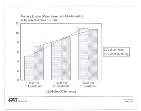
Abb. 4. Jährliche Kosten für die Gülleausbringung (1 Hektare Güllen bei 500 m Feldentfernung) für die Verfahren Vakuumfass (4000 l Inhalt) und Verschlauchungsanlage bei unterschiedlichen Jahresmengen bzw. Verdünnungen.
