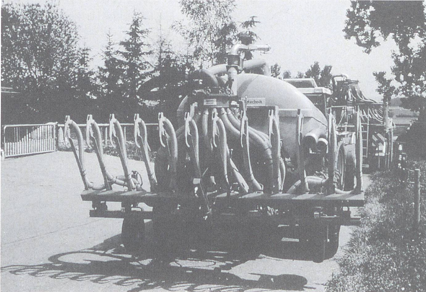
Abb. 9. Schleppschuhverteiler gelten im Ausland für die Verwendung im Futterbau als sinnvolle Alternative, bieten aber in der Schweiz gegenüber dem Schleppschlauch kaum Vorteile.
