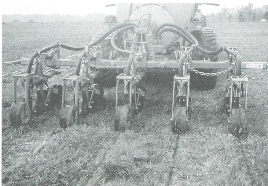
Abb. 12. Tiefinjektor auf Wiesen: Grosser Zugkraftbedarf, Gefahr von Schmier-schäden in kritischer Bodentiefe. Wegen den verbreitet schweren Böden ist die Technik bei uns nicht zu empfehlen.
