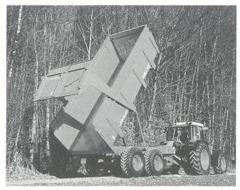
Der französische Hersteller Brimont bietet die Lösung für Transportprobleme mit Schüttgütern verschiedener Art. Die robusten Wannenkipper werden in zwei verschiedenen Baureihen für Nutzlasten von 9 bis 24 Tonnen gebaut. Das gefederte Fahrwerk und die gefederte Deichselabstützung bieten einen unübertroffenen Fahrkomfort auch bei hohen Geschwindigkeiten. Serienmässig sind die Fahrzeuge mit einer automatisch öffnenden Rückwand mit Flügeltüren ausgerüstet. Zudem kann die Rückwand
