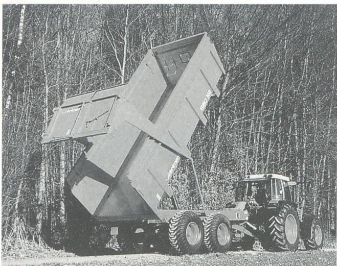
Der französische Hersteller Brimont bietet die Lösung für Transportprobleme mit Schüttgütern verschiedener Art. Die robusten Wannenkipper werden in zwei verschiedenen Baureihen für Nutzlasten von 9 bis 24 Tonnen gebaut. Das gefederte Fahrwerk und die gefederte Deichselabstützung bieten einen unübertroffenen Fahrkomfort auch bei hohen Geschwindigkeiten. Serienmäßig sind die Fahrzeuge mit einer automatisch öffnenden Rückwand mit Flügeltüren ausgerüstet. Zudem kann die Rückwand
