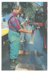
Zuverlässigkeit in der Ausbringung von Pflanzenschutzmitteln dank periodischer Überprüfung der Funktionstüchtigkeit der Feldspritzgeräte.
