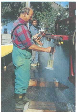
Zuverlässigkeit in der Ausbringung von Pflanzenschutzmitteln dank periodischer Überprüfung der Funktionsstüchtigkeit der Feldspritzgeräte.
