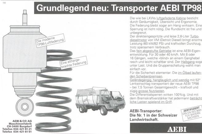
Die wie bei LKWs <u>luftgefederte Kabine</u> besticht durch Geräumigkeit, Übersicht und Ergonomie. Die Federung bleibt sogar am Hang wirksam. Eine Sperrung ist nicht nötig. Die Rundsicht ist frei und unbegrenzt.
