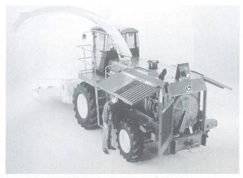
Reparatur- und Wartungszeit machen etwa 12% der produktiven Einsatzzeit eines Feldhäckslers aus. Gute Zugänglichkeit und lange Wartungsintervalle reduzieren die Ausfallzeiten.
