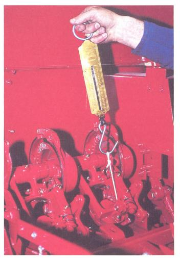
Garnzugspannung am Garnhalter: 30-60 kg
