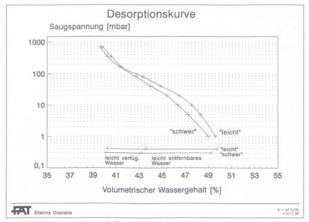
Abb. 7. Desorptionskurve in Grob- und Mittelporenvolumenbereichen, 25 bis 30 cm Bodentiefe. **Grobporen** 0 bis 80 mbar: leicht entfernbares Wasser, **Mittelporen** 80 bis 690 mbar: leicht verfügbares Wasser, 690 bis 15 000 mbar: schwer verwertbares Wasser; **Feinporen** > 15 000 mbar: nicht verwertbares Wasser.
