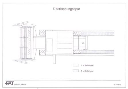
Abb. 4. Fahrspur mit Überlappungsspur beim Mähdrescher (3 m Schnittbreite).
