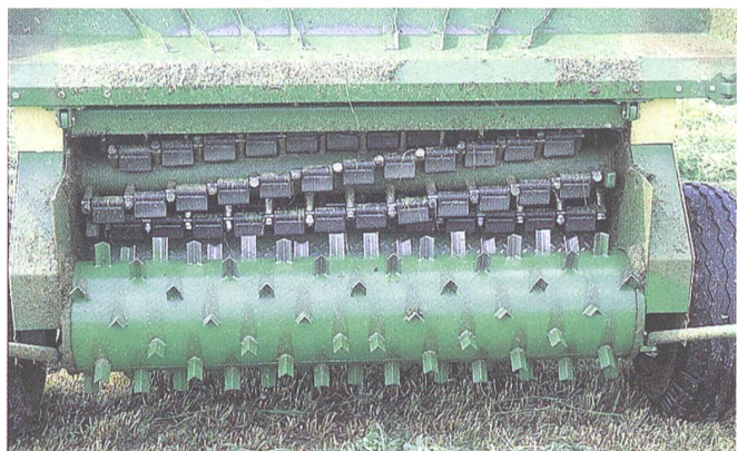
Die Hammerwalze mit den beweglich befestigten Hammerklötzen ist das Herzstück des Krone ICS. Die dahinter laufende Verteilerwalze wirft das Futter gegen die (aufgeklappte) Haube.
