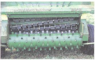
Die Hammerwalze mit den beweglich befestigten Hammerklötzen ist das Herzstück des Krone ICS. Die dahinter laufende Verteilerwalze wirft das Futter gegen die (aufgeklappte) Haube.
