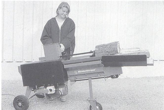
Mit 8 Tonnen Spaltkraft bietet der Ott-Spaltpilot auch unter härtesten Bedingungen genügend Leistungsreserven. Der neue Kurzholzspalter mit liegendem Zylinder und serienmäßig höhenverstellbarem Spaltkreuz überzeugt durch hohe Durchsatzleistung und einfache Bedienung. Die maximale Spaltlänge beträgt 55 cm und kann stufenlos angepasst werden. Transportrollen und die demontierbare Holzrutsche erhöhen die Bedie-
