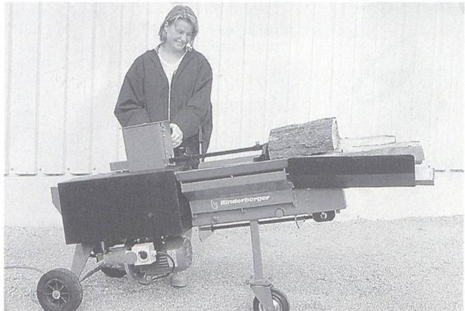
Mit 8 Tonnen Spaltkraft bietet der Ott-Spaltlader auch unter härtesten Bedingungen genügend Leistungsreserven. Der neue Kurzholzspalter mit liegendem Zylinder und serienmäßig höhenverstellbarem Spaltkreuz überzeugt durch hohe Durchsatzleistung und einfache Bedienung. Die maximale Spaltlänge beträgt 55 cm und kann stufenlos angepasst werden. Transportrollen und die demontierbare Holzrutsche erhöhen die Bedie-
