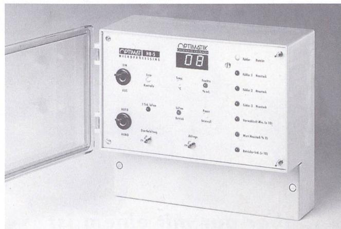
Bei den vollelektronischen Optimatik-Heubelüftungssteuerungen ermitteln elektronische Messsonden dauernd die relative Luftfeuchtigkeit und die Temperatur der Zuluft sowie der aus dem Stock austretenden Luft. Neu wird am Steuergerät auch angezeigt, wieviel Wasser effektiv dem Heustock entzogen wird. Die Heutrocknung wird dadurch noch effizienter.
