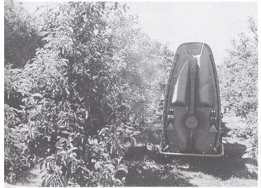
Abb. 5. Beim Umkebraxialgebläse mit hobem Aufsatz werden die Tropfen über relativ kleine Entfernungen zu den Zielflächen mit Luftstrom getragen (Fischer 800, Blattbedeckungs-Messungen)
