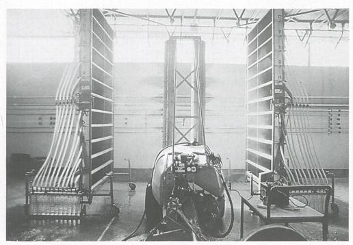
Für die Mittelverteilung und -anlagerung sind zudem Wassermenge/ha, Tropfengrösse, Gebläseart, Luftfördermenge, -geschwindigkeit und -führung sowie die Fahrgeschwindigkeit massgebend.
