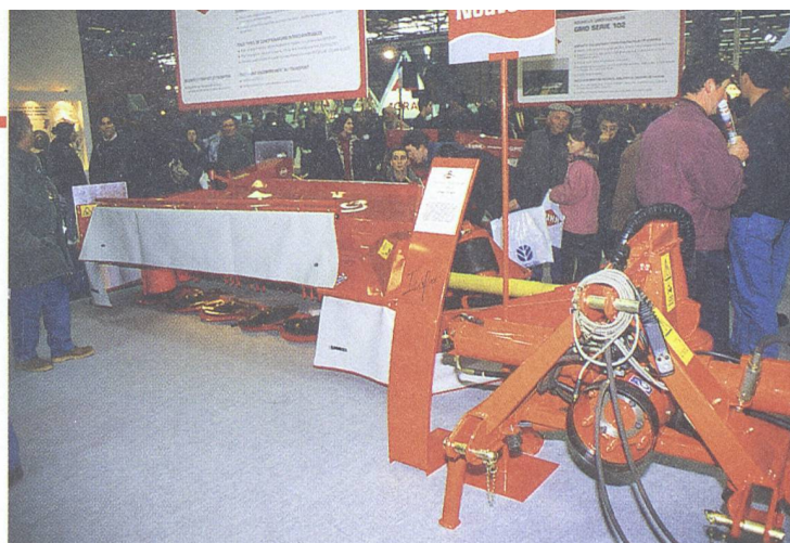
Neues Scheibenmäbwerk (Kubota) mit Abstellschemel und Klappmechanismus für die Strassenfahrt.
