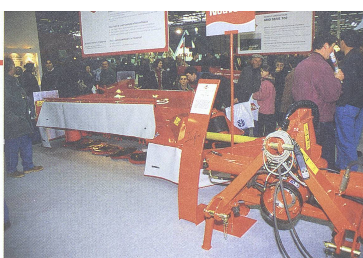
Neues Scheibenmäbwerk (Kuhn) mit Abstellschemel und Klappmechanismus für die Strassenfahrt.
