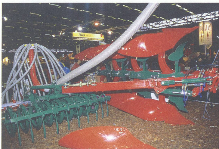
Kombination von Pflug und pneumatischem Säaggregat (Kverneland).
