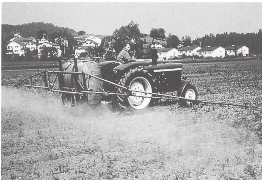
Abb. 4. Der Vielzwecktraktor der 70er Jahre hatte eine Motorleistung von 45 bis 55 PS, Hinterradantrieb, Normzapfwelle und eine Dreipunkthydraulik. Sein Gewicht lag unter 2500 kg.
