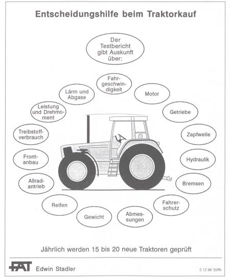
Abb. 1. Das Prüfprogramm ist umfassend und gibt zu wichtigen technischen Merkmalen des Traktors Auskunft.
