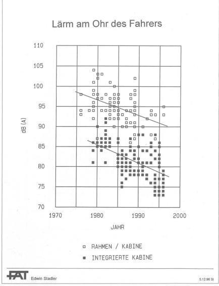
Abb. 11. Die Lärmwerte, gemessen an Traktoren ausgerüstet mit einfachen Fahrerkabinen oder Rahmen, liegen zum Teil noch immer weit über 90 Dezibel – ein Lärmwert, den es unbedingt zu vermeiden gilt. Erfreulich sind dagegen jene der integrierten Kabinen, die den Wert von 80 Dezibel zunehmend unterschreiten.
