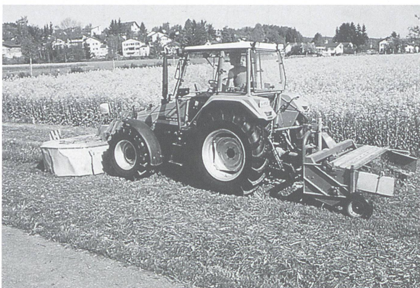
Abb. 6. Die schräg nach vorne abfallende Motorhaube bringt eine willkommene Verbesserung der Sicht auf das Frontgerät sowohl beim Geräteanbau als auch im Feldeinsatz.
