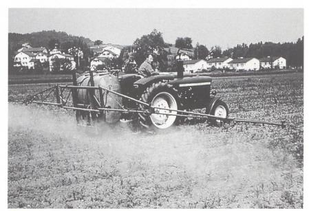
Abb. 4. Der Vielzwecktraktor der 70er Jahre hatte eine Motorleistung von 45 bis 55 PS, Hinterradantrieb, Normzapfwelle und eine Dreipunkthydraulik. Sein Gewicht lag unter 2500 kg.
