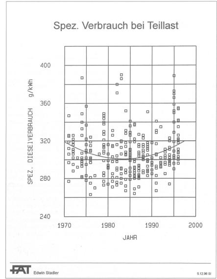
Abb. 9. Der spezifische Treibstoffverbrauch bei Teilbelastung verringerte sich von 320 g/kWh im Jahre 1970 auf 300 g/kWh im Jahre 1985. Seither ist wieder ein merklicher Anstieg feststellbar. Grund: Die Leistungsverluste, hervorgerufen durch Lastschaltgetriebe, Hydraulikpumpen und anderen Hilfseinrichtungen treten verstärkt zutage.
