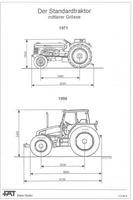
Abb. 7. Veränderung des Standardtraktors mittlerer Grösse in den letzen 25 Jahren. Oben dargestellt der Traktor Hürlimann Typ D 110 (FAT-Testbericht Nr. 01/71) mit einer Motorleistung von 40 kW (55 PS) und einem Gewicht von 2145 kg. Unten ein moderner Vielzwecktraktor Steyr Typ M 975 (FAT-Testbericht Nr. 1706/95) mit einer Motorleistung von 55 kW (75 PS), ausgerüstet mit integrierter Fahrerschutzkabine, Allradantrieb und Frontanbau. Das Gesamtgewicht des Traktors beträgt 3300 kg.
