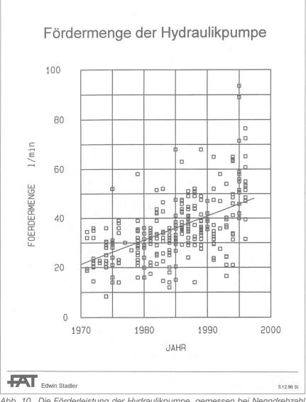
Abb. 10. Die Förderleistung der Hydraulikpumpe, gemessen bei Nenndrehzahl des Motors, verdoppelte sich in den letzten 25 Jahren von durchschnittlich 22 I/min auf 46 I/min.
