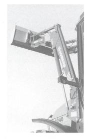
allen parallelgeführten Ladern die Hydraulikleitungen um 25 Prozent. Sämtliche lieferbaren Konsolen wurden gemäss den Ansprüchen der Traktorenhersteller konstruiert. Sie sind für alle bekannten Marken lieferbar. Die An- und Abbauzeiten der Howard-Lader sind sehr kurz. Howard-Frontlader werden bei Nordsten in Skive, Dänemark, hergestellt.
