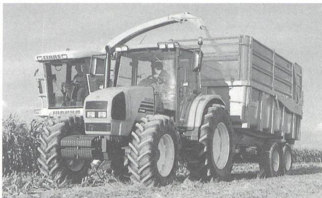
Drivetronic steht bei ARES für eine «intelligente Elektronik», die nicht nur überwacht, sondern in Abhängigkeit der Fahrgeschwindigkeit, der Hubwerkslage oder der Zapfwellenbelastung selbsttätig Steuerungsmechanismen und Schaltvorgänge auslöst.
