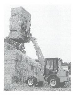
Abmessungen zum Beispiel beim Teleskoplader von Schäffer: Technische Daten: 50 PS Kubota-Dieselmotor, hydrostatischer Allradantrieb mit 2 Fabrstufen (Höchst-
