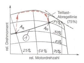
Abb. 2. Beispiel des Regelverhaltens eines Alldrehzahlreglers auf einer Arbeitswiderstandslinie  $\odot$  vom alten Arbeitspunkt  $A_a$  zum neuen Arbeitspunkt  $A_n$ .
