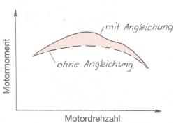
Abb. 5. Erhöhung des Momentenanstiegs durch Angleichung der Einspritzmenge.
