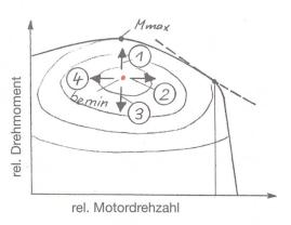
Abb. 3. Einflüsse auf den Verlauf der Linien gleichen spezifischen Kraftstoffverbrauchs
