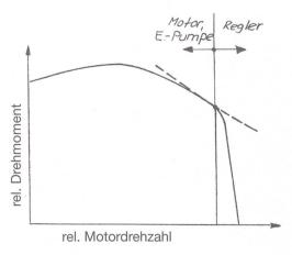
Abb. 4. Einflussbereiche auf die Kennlinienverläufe.
