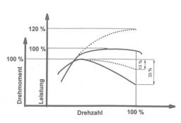
Abb. 8. Möglichkeit der bedeutenden Verringerung der Momentenelastizität und Erhöhung der Motornennleistung (gepunktet) bei Verwendung eines stufenlosen Getriebes am Beispiel des Claas-Xerion.
