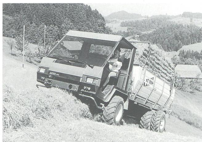
*Der neu entwickelte Transporter Aebi TP98 erspart dem Benutzer dank der neuen Luftfederung und weiteren wegweisenden Komfortelementen alle unnötigen Strapazen. Er bietet mehr Nutzlast, einen neuen leistungsfähigen und durchzugsstarken VM-Dieselmotor, ein neues Getriebe und 52° Lenkeinschlag.*
