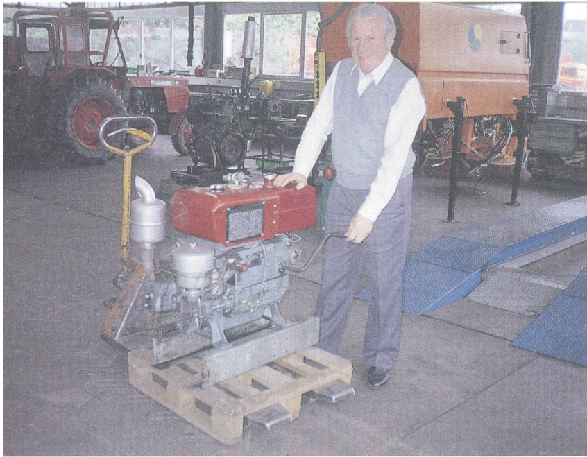
Willi Mahler mit dem umgebauten chinesischen Jiang-Dong-Dieselmotor, mit einem liegenden Zylinder und Wasserkühlung. Der Motor ist für den Betrieb mit Rizinusöl in einem brasilianischen Projekt vorgesehen. (Bild: Martin Meyer)
