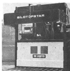
Der erste Blockschneider mit horizontalem Doppelmesserschnitt.
