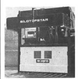
Der erste Blockschneider mit horizontalem Doppelmesserschnitt.
