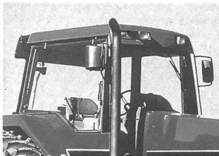
Geschlossene Kabine und Klimaanlage: Wärme, Schall und Luftverunreinigungen bleiben draussen
