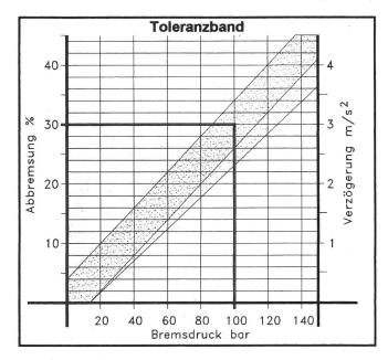
Die Grafik erlaubt eine Grobbeurteilung der Bremsanlage, wobei immer die Bauart und das Gesamtgewicht des Anhängers einbezogen werden müssen.
