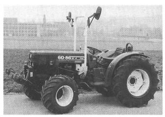
Abb. 7. Mähtraktor FIAT 60–86 F, mit Fronthydraulik und Frontzapfwelle.
