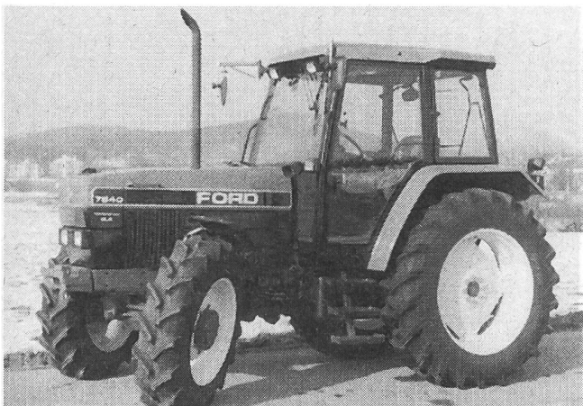
Abb. 4. Traktor FORD 7840, mit 4-Stufen-Lastschaltgetriebe (Electro Shift).
