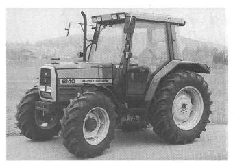
Abb. 2. Traktor MASSEY FERGUSON 6140 Turbo, mit 4-Stufen-Lastschaltgetriebe (Dynashift).
