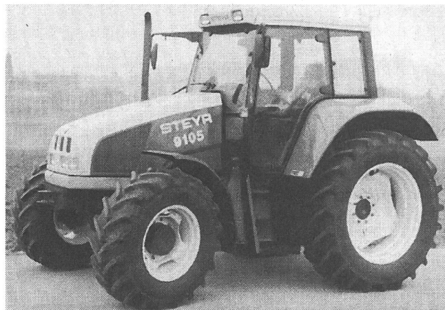
Abb. 3. Traktor STEYR 9105 Turbo, mit 4-Stufen-Lastschaltgetriebe (Steyr-Power).
