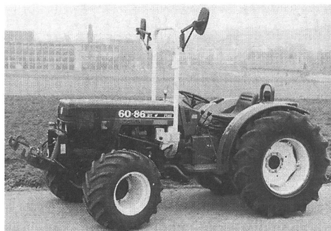
Abb. 7. Mähtraktor FIAT 60-86 F, mit Fronthydraulik und Frontzapfwelle.
