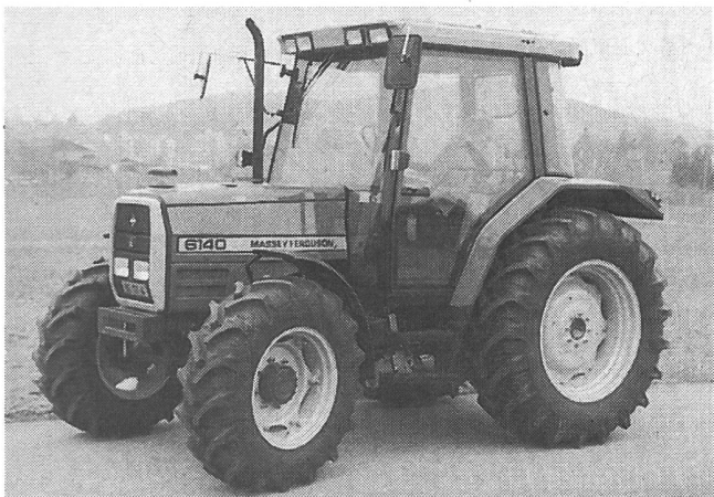
Abb. 2. Traktor MASSEY FERGUSON 6140 Turbo, mit 4-Stufen-Lastschaltgetriebe (Dynashift).
