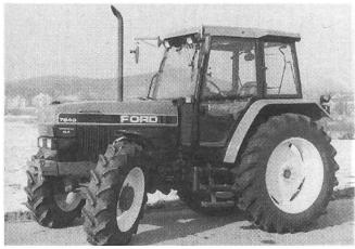
Abb. 4. Traktor FORD 7840, mit 4-Stufen-Lastschaltgetriebe (Electro Shift).
