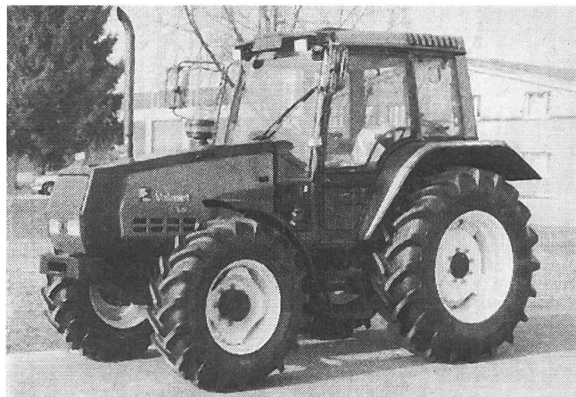
Abb. 1. Traktor VALMET 6400 Turbo, mit Flüssigkeitskupp- lung und 3-Stufen-Lastschaltgetriebe (Powershift).
