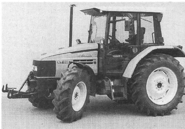
Abb. 5. Traktor HÜRLIMANN XT908 Turbo, mit 3-Stufen-Lastschaltgetriebe, Fronthydraulik und Frontzapfwelle.
