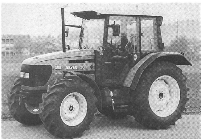
Abb. 6. Traktor SAME Silver 100.6, mit 3-Stufen-Lastschaltgetriebe, Fronthydraulik und Frontzapfwelle.
