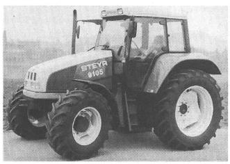
Abb. 3. Traktor STEYR 9105 Turbo, mit 4-Stufen-Lastschalt-getriebe (Steyr-Power).
