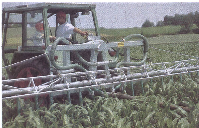
Zwei «rotierende, hydraulisch verstellbare Förderorgane» beschicken die Schläuche gleichmässig mit Gülle oder Klärschlamm und verhindern Verstopfungen.
