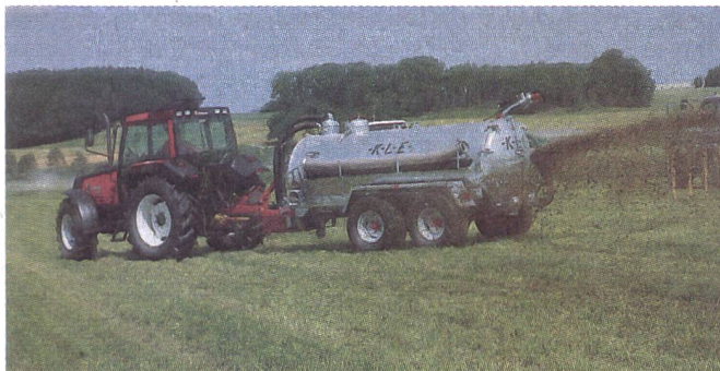
Durch den Arbeitsdruck angetriebener Schwenkverteiler. Flacher Strahl mit einer Verteilbreite bis 16 m.
