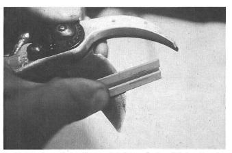
3. Bei jedem Schleifen entsteht auf der Rückseite der Schneide ein feiner Grat. Bricht nun dieser Grat von selbst ab, so erhält man keine absolut scharfe Schneide. Deshalb muss man den Grat mit dem Schleifstein auf der Rückseite der Klinge abziehen. Der Schweizer Hersteller von Baumund Rebscheren, Felco AG in Les Geneveys-sur-Coffrane NE, empfiehlt dabei einen Schleifwinkel von ca. 5° einzuhalten.
