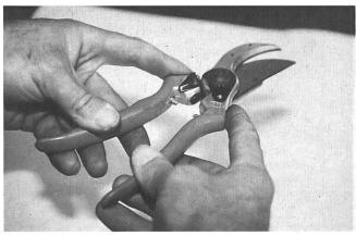
6. Das Klingenspiel muss nun so eingestellt sein, dass sich die Schere noch leicht öffnen und schliessen lässt. Hält man die Schere wie hier abgebildet, kann dies leicht überprüft werden. Klinge und Gegenschneide müssen auch bei fast geöffneter Schere noch satt aneinander liegen. Die Einstellung wird dann mit dem Zahnsegment gesichert.
