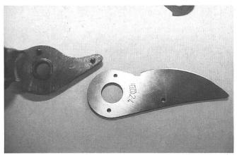
4. Sämtliche Bestandteile einer Felco-Schere können unter Angabe des Scherentyps einzeln gekauft und leicht ausgewechselt werden. Ist ein Klingenwechsel erforderlich, zerlegt man die Schere soweit, bis die alte Klinge aus den drei Klingenstiften gelöst werden kann. Um einen festen Sitz der neuen Klinge gewährleisten zu können, muss die Auflagefläche entsprechend gesäubert werden. Für den Notfall werden neue Stifte mit der Ersatzklinge mitgeliefert.
