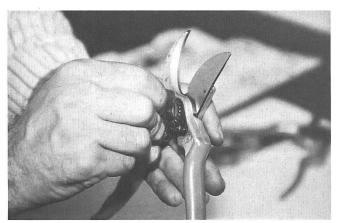
5. Die Schere wird nun soweit montiert, dass über die gezahnte Mutter das Klingenspiel eingestellt werden kann. Bolzen, Lagerbüchse und Gleitflächen werden zuvor geschmiert. Damit sich die Verschlussplatte beim Einstellen nicht mitdreht, ist es nützlich, vorher die Sicherungsschraube einzudrehen.
