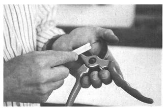
2. Zum Schleifen, die Schere flach in der Hand halten. Unter Einhaltung des Originalwinkels von 23° wird dann die Schneide auf der ganzen Länge nachgeschliffen. Mit dem handlich geformten Keramikschleifstein des Baumscheren-Herstellers gelingt es, einen sauberen Schliff zu erzielen.
