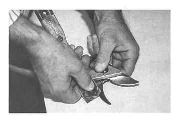
1. Vor dem Schärfen muss die Klinge soweit gereinigt werden, dass sich später kein Schmutz am Schleifstein festsetzen kann. Die Saftrille in der Gegenklinge befreit man mit einem Schaber von angetrockneten Pflanzenresten.
