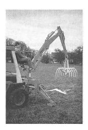
Daraus resultiert eine optimale Gewichtsverteilung für den Transport. Arbeitstiefe mit Mistzange 2,30 m, mit Grablöffel 1,80 m. Hubkraft auf 3,70 m beträgt 350 kg, Gewicht ca. 470 kg.
