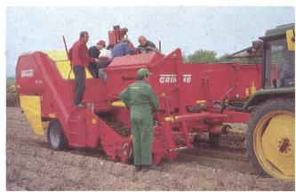
Der einreihige Vollernter ist universeller einsetzbar und wird mit Steinen und Kraut besser fertig als der Rodelader.
