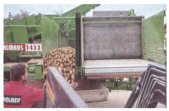
Mit dem separaten Bunker für die Untersortierung lässt sich auf dem einreihigen Vollernter in einem Arbeitsgang marktfähige Ware ernten.
