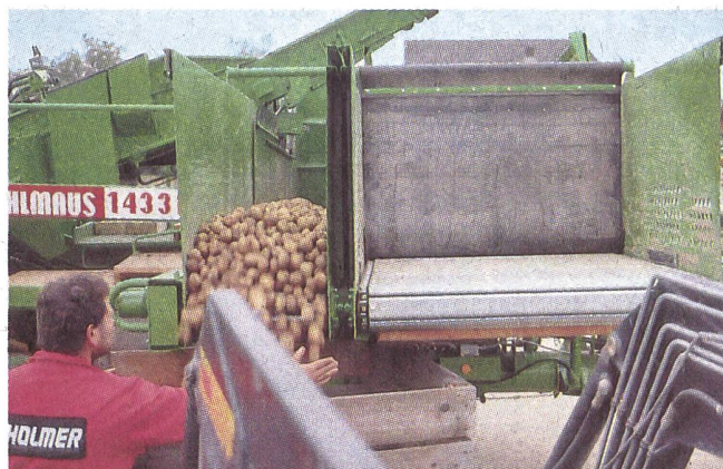
Mit dem separaten Bunker für die Untersortierung lässt sich auf dem einreihigen Vollernter in einem Arbeitsgang marktfähige Ware ernten.
