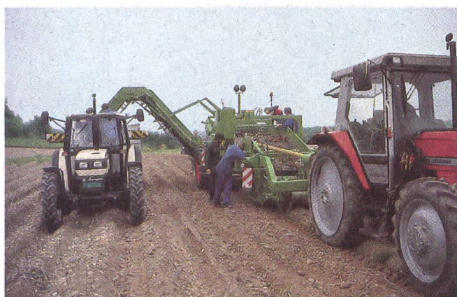
Der zweireihige Rodelader ist auf nahezu stein-, kluten und krautfreie Verhältnisse angewiesen, um seine Vorteile auszuspielen.
