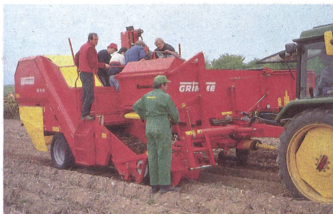
zätzlich Der einreihige Vollernter ist universeller einsetzbar und wird mit Steinen und Kraut besser fertig als der Rodelader.
