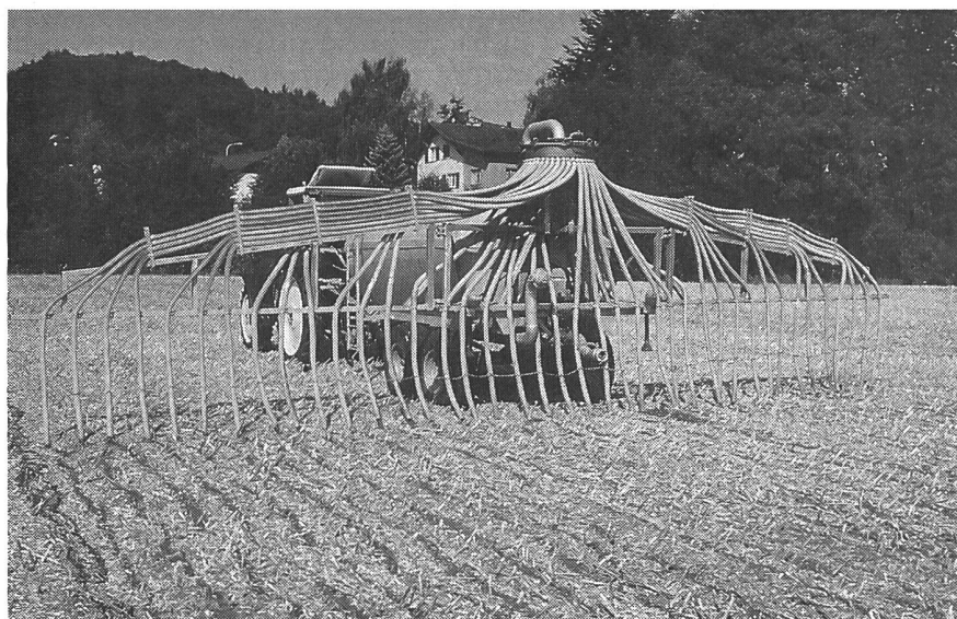
Abb. 11. Schleppschlauchverteiler legen die Gülle bodennah und bandförmig auf dem Boden ab. Die auf einen Drittel reduzierte Kontaktfläche der Gülle hat deutlich geringere Ammoniakverluste zur Folge.
