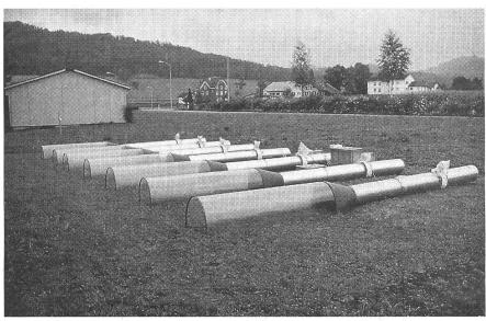
Abb. 2. Windtunnelanlage zur Messung von Ammoniakverlusten: Indem ein bestimmter Parameter (z.B. der Verdünnungsgrad) in Stufen variiert wird, kann dessen Einfluss auf die Verluste gezielt untersucht werden.
