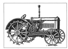
IHC-Traktor 10-20, Jahrgang 1926, mit Riemenscheibe und Heckzapfwelle.
