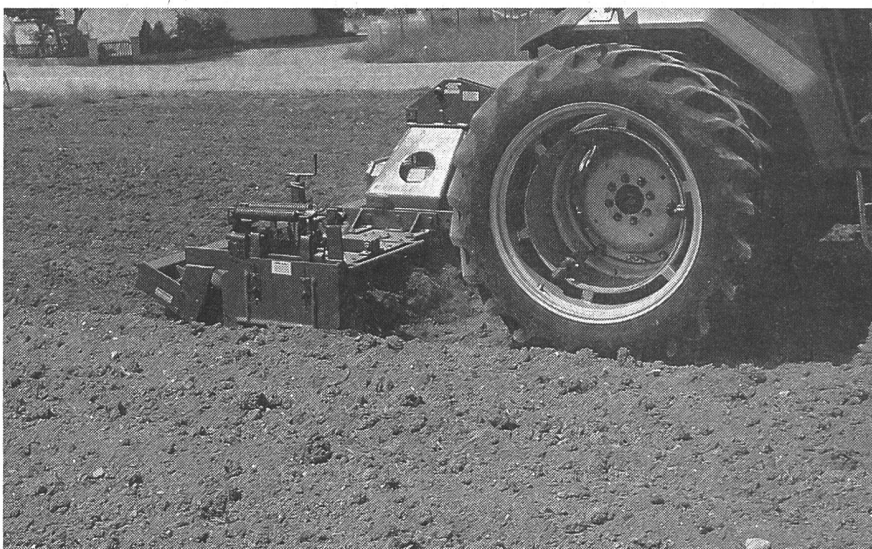
Abb. 3. Die Kreiselegge ebnet die Felder gut ein, arbeitete am feinsten und benötigt bei höheren Fahrgeschwindigkeiten einen erhöhten Zugkraftbedarf.
