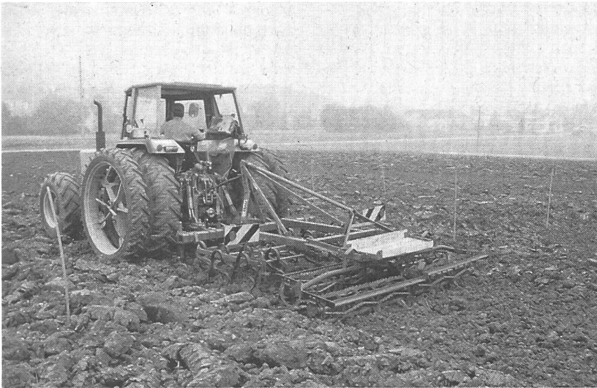
Abb. 4. Die Federzinkenegge benötigt einen sehr kleinen Energiebedarf, ist sehr kostengünstig und erzeugt auf den mittelschweren Böden grobe Saatbetten, die bei Winterweizen aber nie Mindererträge zur Folge hatten.
