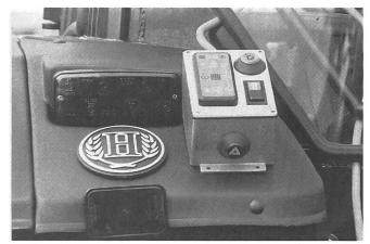
Die SLH-Fernbedienung ist in einem schlagfesten Kästchen untergebracht. Gut sichtbar sind die Bedienungstasten für Motordrehzahl, Getriebe und Zapfwelle sowie der Notstopp.
