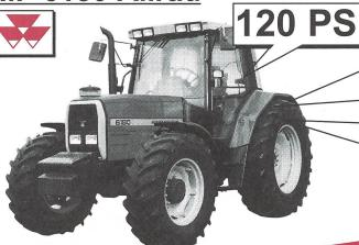
mit elektrohydraulischer Reversierung mit neuer Komfort Kabine (72 dba) mit 4-Stufen-Dynashift-Lastschaltgetriebe mit Fahrkupplung im Ölbad
