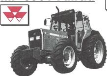
mit DE LUXE Kabine mit 4-Zylinder Perkins-Turbo Motor mit 18/6-Speedshift Getriebe mit Seitenschaltung
