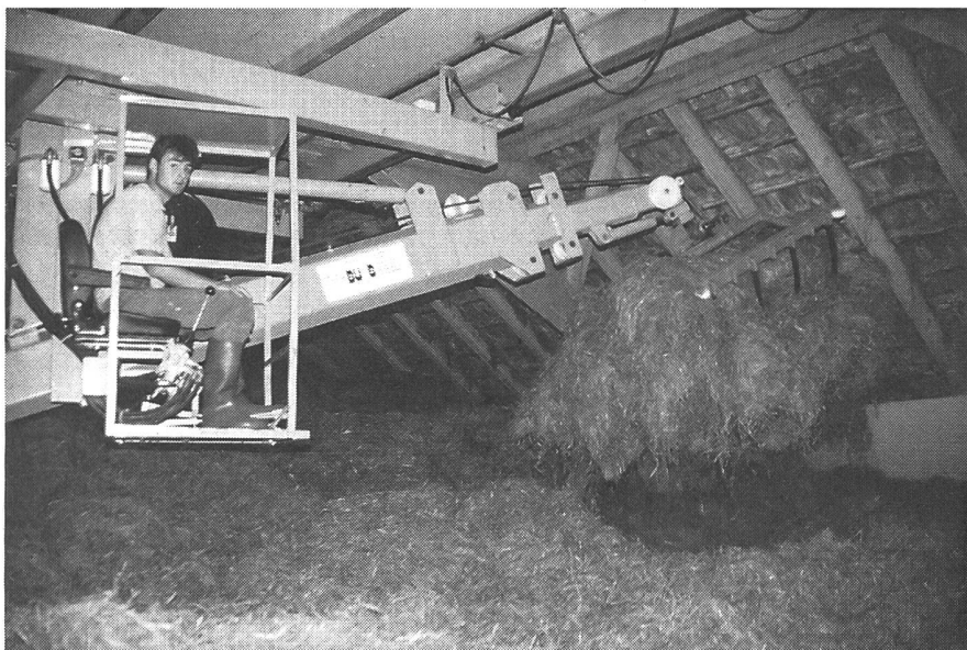
Abb. 7. Greiferkrananlagen dienen der Ein- und Auslagerung von Tierfutter. Ölverluste, hervorgerufen durch Leckagen, könnten sich bei Verwendung von Mineralöl negativ auf die Tiergesundheit auswirken.
