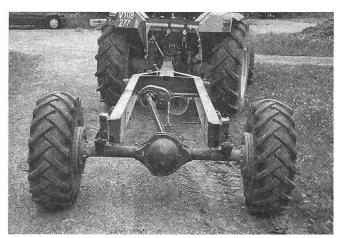
Das Grundgerät ist in den Massen und der Bereifung (11,5/80 –15,3) dem Reform-Muli 600 (SL) nachempfunden. Der Rahmen sitzt auf einer IVECO-Magirus-Achse, die über einen eigenen Wegzapfwellenstummel und ein dazwischengeschaltetes Triebachsgetriebe vom Traktor her angetrieben wird.
