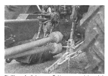
Die Wegzapfwelle kann vom Traktor aus zu- und abgeschaltet werden. Auch das Schalten des Triebachsgetriebes folgt vom Traktorsitz aus. (Fotos B. Wimmer)
