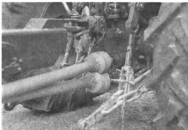
Die Wegzapfwelle kann vom Traktor aus zu- und abgeschaltet werden. Auch das Schalten des Triebachsgetriebes folgt vom Traktorsitz aus.
