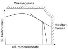
Abb. 6. Grundsätzliche Kennfeldgrenzen für funktionssichere Motoren.
