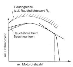
Abb. 5. Begrenzung der Motorvollast durch die Rauchdichtegrenze (schematisch).
