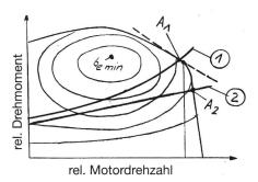
Abb. 3. Motorkennlinienfeld mit Beispielen eingetragener Arbeitswiderstandslinien (Messung oder Berechnung: • Pflügen; • Drillsaat). Wird jeweils die volle Leistung in Anspruch genommen, arbeitet der Motor in den Arbeitspunkten A1 bzw. A2.
