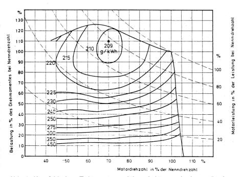
Abb. 1. Kennfeld eines Traktormotors mittlerer Leistung mit einem günstigen Verbrauchsverhalten, gutem Momentenanstieg, aber mässigem Momentenverlauf.
