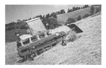
und vor allem Bodenschonung, weil Vorder- und Hinterräder gleiche Lenkeinschläge aufweisen und dadurch verspannungsfrei abrollen. Die Allradlenkung kann im Bedarfsfall rasch auf die Front-, Heck- (nur Metrac 4004/H) oder Hundeganglenkung umgeschaltet werden.
