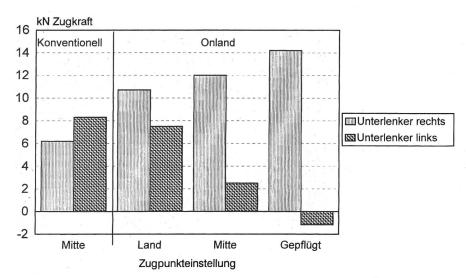
Abb. 3: Lage des Zugpunktes (vgl. Abb. 1) und die in den Unterlenkern auftretenden Zugkräfte (kN). Durchschnitt von zwei Pflügen gemessen auf dem Standort Lagerfeld (Standardabweichung je Einstellung < 1,6 kN).
