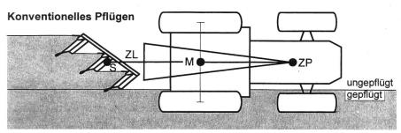
Abb. 1: Die Lage der Zuglinie (ZL) und des Zugpunktes (ZP) bestimmt das Auftreten von Seitenzug (Sz) und erhöhten Anlagendruckes (A) bei den verschiedenen Pflugeinstellungen.
