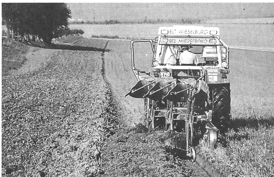
Onland-Pflügen: Kein Rad verdichtet und verschmiert den Furchengrund.
