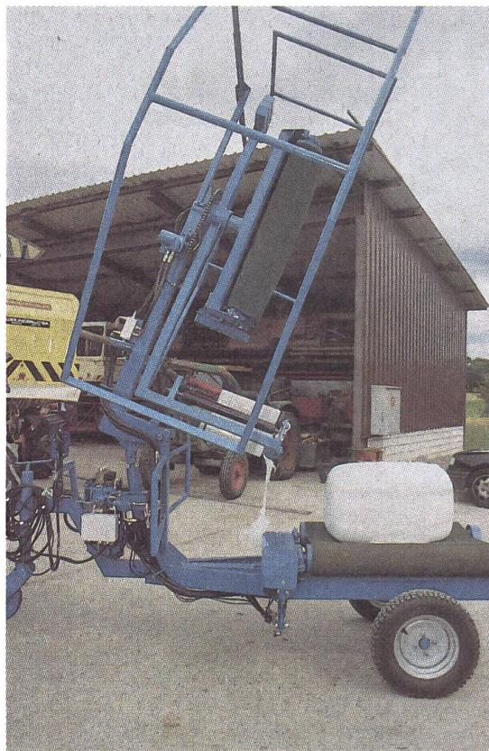
Minimalausrüstung ohne Ballenaufnahme mit automatischem oder von Hand geschaltetem Wickelvorgang (Kostenpunkt Fr. 16 000.-). Der Sicherheitsrahmen ist für die Strassenfahrt zusammenschiebbar. (Fotos: Zw).
