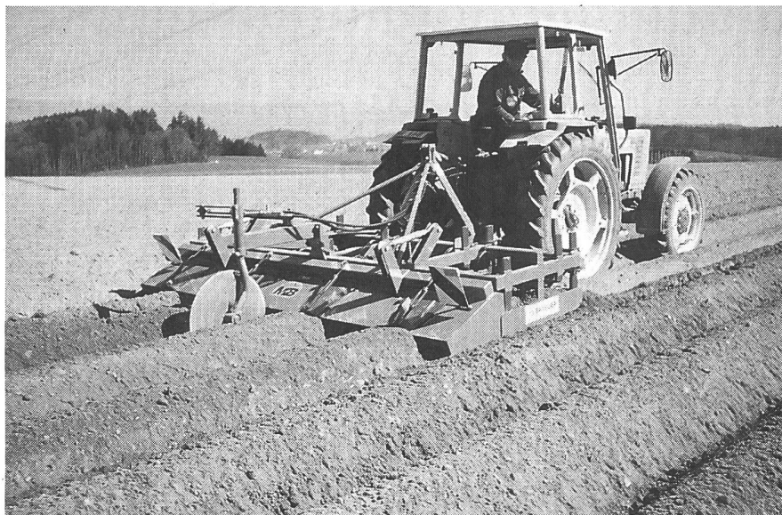
Dammformgerät (ohne Walze und Sägerät) einsetzbar zum Anhäufeln und zur Unkrautregulierung. Verstellbare Klappen sorgen dafür, dass das Kartoffelkraut bis 35 cm unversehrt durchkommt. (Bild Möri)
