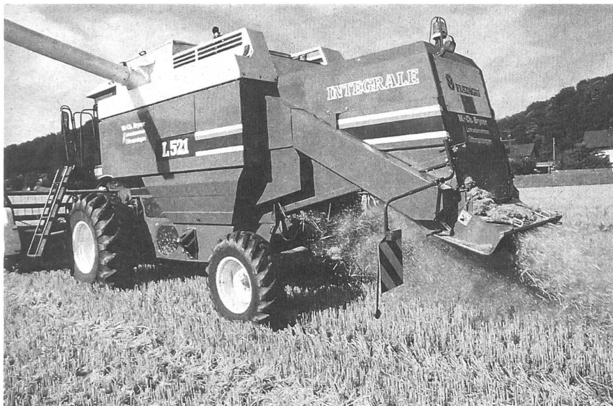
Strohhäcksler – zur Grundausrüstung auf jedem Mähdrescher geworden. Die Verteilgenauigkeit des Strohs ist nicht über jeden Zweifel erhaben. Insbesondere müsste es auch gelingen, je nach Windverhältnissen die Abdrift auszugleichen.
