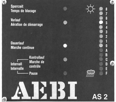
Abb. 1. Steuergerät mit Messung der Lufttemperatur beim Ansaug und an der Stockoberfläche.
